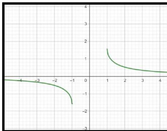
Figura. 3.38 Grafica de la función  $\text{arccsc}(x)$
